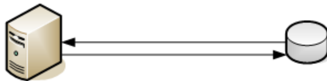
Topologie point à point (FC-P2P)
